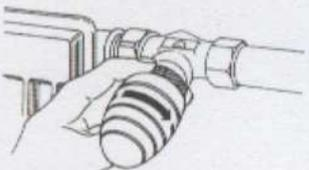
3. Napęd ręczny lub nakrętkę kapturową przy napędzie „D” odpowiednio dokręcić kluczem.
