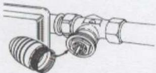
2. Napęd ręczny w formie dostarczonej (w stanie całkowitego otwarcia) nakręcić lub zatrzasknąć na zaworze.
