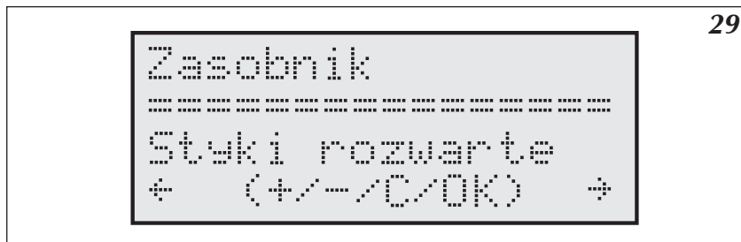
Rys.29 Strona zasobnika w przypadku zastosowania termostatu.
