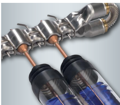
W dwururowym wymienniku ciepła Duotec, kondensatory na dużej powierzchni oddają efektywnie ciepło z parującego nośnika ciepła do czynnika grzewczego
