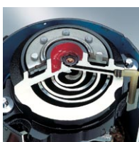
Sprężarka Compliant Scroll zapewnia wysokie bezpieczeństwo eksploatacji, niezawodność i cichą pracę
