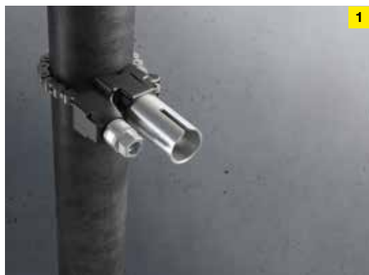
1. Na rurze mocuje się specjalny uchwyt do prowadzenia wrzeciona wiertarki.
